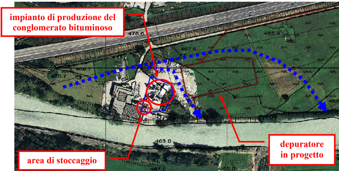
Schema basato sulle pendenze con la dinamica di una eventuale fuoriuscita della Dora Baltea a monte su base ortofoto 2012
